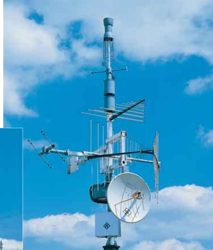
Cubriendo un rango de frecuencias de 10 kHz a 3 GHz: Antenas R&S AU900A5 (izquierda) y R&S AU900A4 (derecha)
